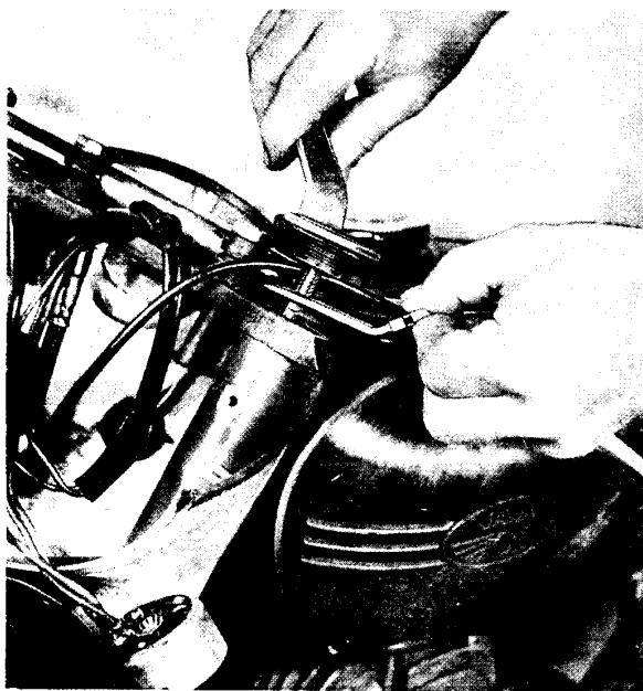
Bild 61-2. Avskruvning av toppmuttern från dämparstången.
