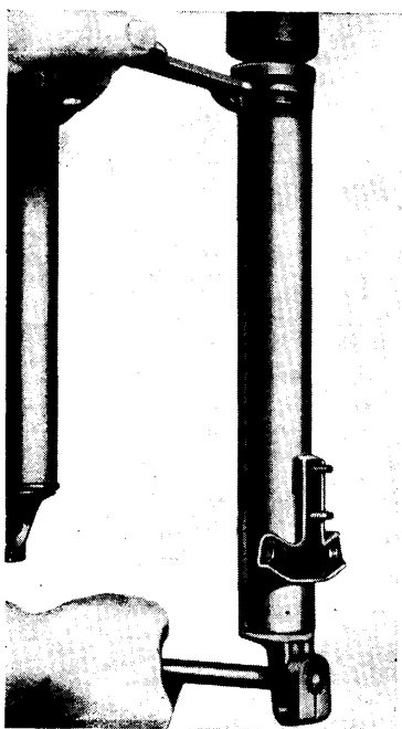
Bild 61-7. Lossning av glidrörs- muttern.
