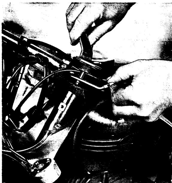
Bild 61-2. Avskruvning av toppmuttern från dämparstången.
